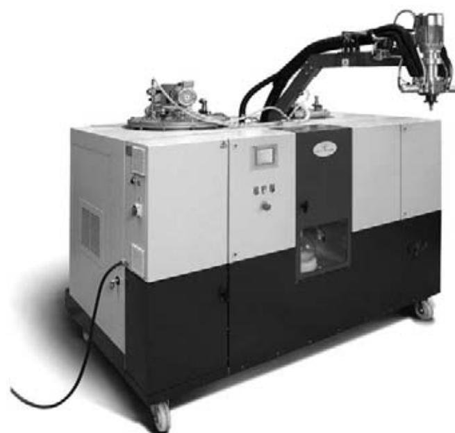
и ритмичность работы оборудования. Все машины изготавливаются индивидуально, с точным учетом всех требований заказчика. Для их реализации POLYTEC EMC предлагает многочисленные опции: встроенные вакуумные насосы, узлы подачи пигментов для получения окрашенных изделий, расходомеры для точного учета сырья и т. п.
