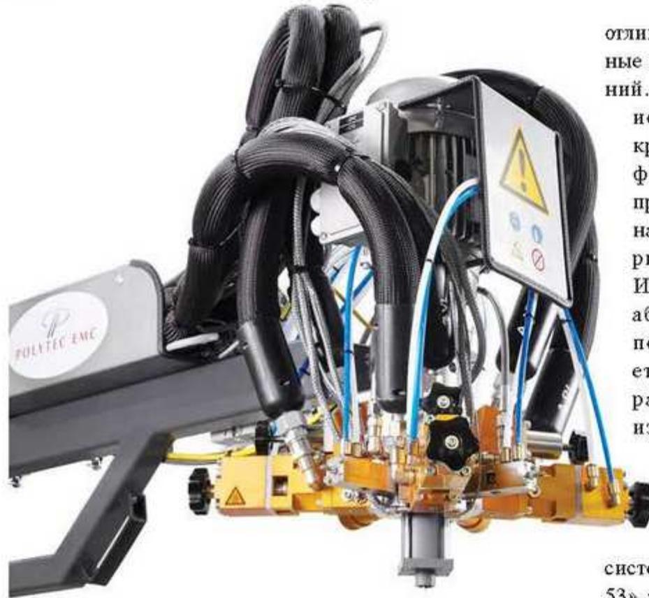
различного назначения длиной до 3,5 м и диаметром до 0,5 м; уплотнители; демпферы и траки; детали подвески рельсового и автомобильного транспорта. Разработанная технология литья полиуретанов в эластичные формы, изготавливаемые за 24 часа по образцу детали или ее модели, позволяет быстро воспроизводить продукцию сложной формы и экономически эффективна даже при выпуске единичных изделий.
