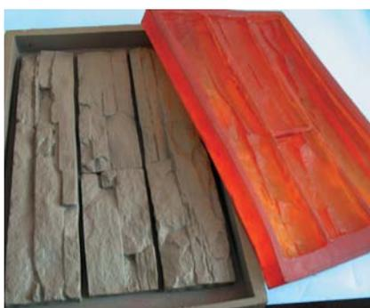
**ПАМ 2060 и ПАМ 2070** – новая разработка фирмы Synair – прочные, износостойчивые материалы применяемые как штампы в бетонном производстве.
