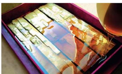
ется воском или пластилином калиброванными по толщине (обычно 7–10 мм). Сверху заливается кожух. После снятия воска между кожухом и моделью образуется равномерный зазор, куда и заливается формовочный материал. Основные преимущества – экономия материала и получение равномерной и не толсто-стенной формы, которую можно аккуратно снимать с изделия «вывороткой», как бы свертывая форму в рулон. Это продлевает срок использования формы и исключает повреждение изделия. Недостатки – трудоемкость метода.
